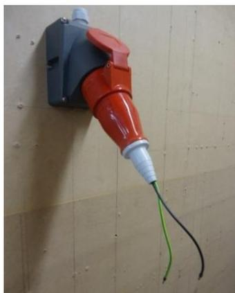
Подготовленные разъёмы соединяется с соответствующими разъёмами ЭУ. К полученным проводникам подключаются электроды мегомметра. Напряжение – 250, 500В.
